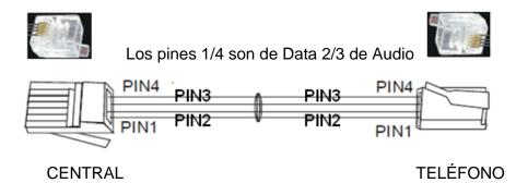
**IMPORTANTE:** Si va a extender el cable que viene con el teléfono operador es muy importante verificar que el par interno del plug de la central (PIN2/PIN3) no sea confundido con el par externo (PIN1/PIN4), Si esto sucede puede dañar el equipo o el teléfono. Si luego de haber leído este mensaje sigue teniendo dudas por favor no conecte el teléfono y llámenos al 4403512 para asesorarlo.
